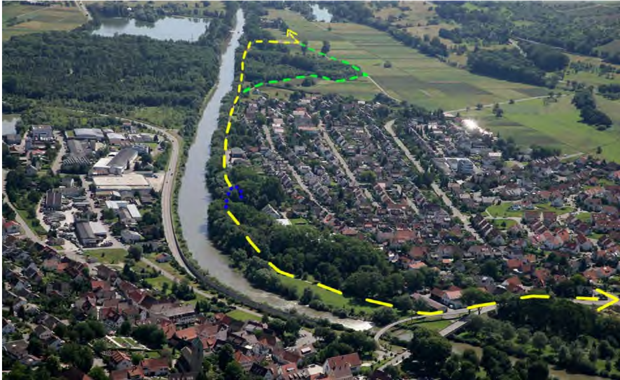
Abb.4: Der optimierte Wegverlauf (gelb) führt entlang des Neckars. Grün dargestellt ist eine mögliche Variante, falls wasserschutzrechtliche Belange dem gelben Wegverlauf entgegenstehen. Der notwendige Steg ist blau dargestellt (Bildquelle: Achim Mende)
