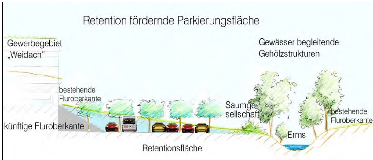
Abb.2: Anhand des Schnittes wird deutlich, wie durch die Entstehung des Gewerbegebietes die Retention im Hochwasserfall gefördert werden kann
